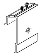
**держатель панелей алюминиевый верхний с регулировочным винтом и стопорным саморезом**
